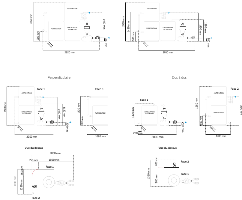
FIG. 6 : VARIANTES DE MONTAGE À 2 ÉTAGES DE LA VITII 15
