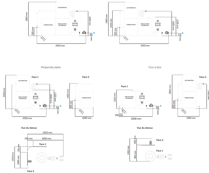
FIG. 6: MONTAGEVARIANTEN VAN DE VITII 15 MET TWEE NIVEAUS.
